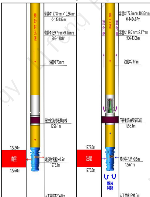
Схема колонны насосно-компрессорных труб для проведения операции
